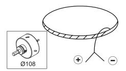
350mA - min 16,5Vf - max 19,2Vf - 6,2W 500mA - min 17,1Vf - max 19,8Vf - 9,2W
